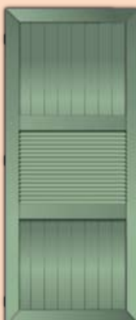
Volet mixte avec traverse à lames occultantes ou ajourées
