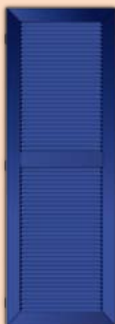
Volet persienné avec traverse à lames occultantes ou ajourées
